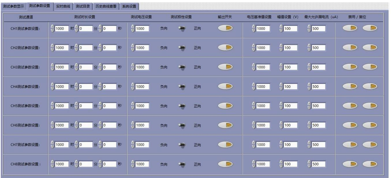
1. 可设定测试时长、测试电压大小、电压施加方向
