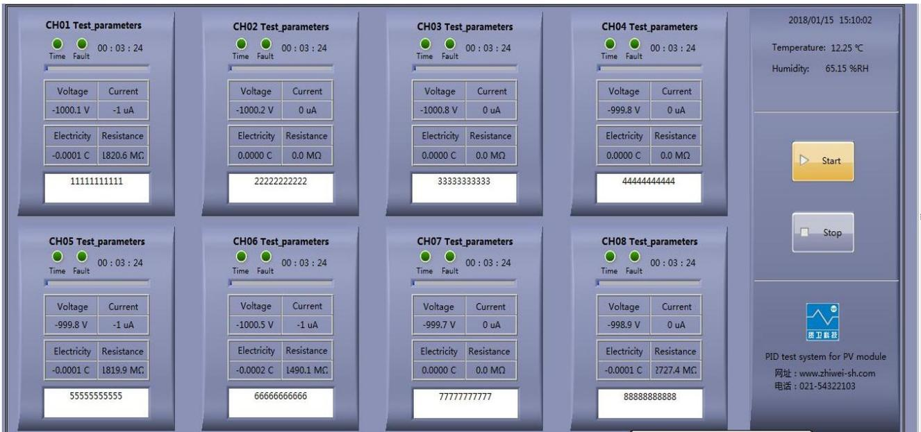
实时监控组件电压、泄露电流、绝缘电阻、泄露电量参数，显示每个通道运行时间、状态及序列号。
